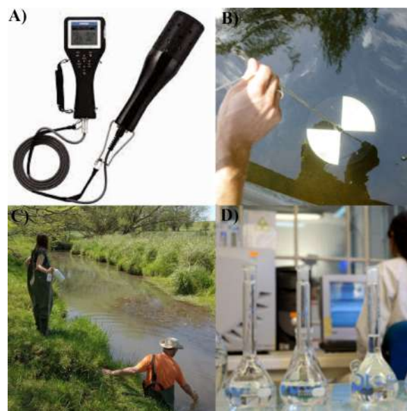
Fig. 5. Instrumentos utilizados para la medición de variables físico-químicas del agua. A) sonda multiparamétrica para medir in situ (directamente en el lugar) parámetros físico-químicos del agua, B) disco de Secchi para medir la transparencia del agua, C) recolección de muestra de agua, D) procesamiento de las muestras de agua en el laboratorio.
